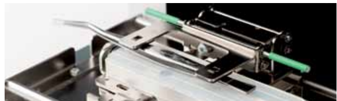
▲ Befestigen Sie den zu markierenden Gegenstand am Arbeitstisch des Geräts
